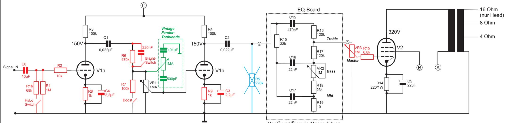
Von @ und Ⓟ sowie Masse führen Kabel zu einem Ministecker auf der EQ-Platine. @ und Ⓟ sind die Anschlüsse für R15 beim Valve Jr. Die Nummerierung der Bauelemente ist so auf der EQ-Platine aufgedruckt.
